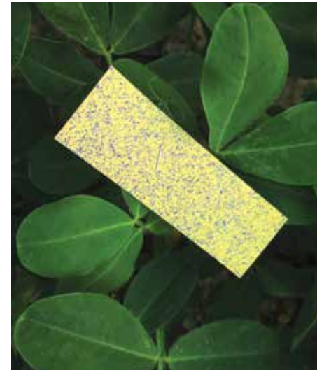
Hình minh họa: 2 ví dụ về kết quả sử dụng thẻ kiểm tra giọt phun (cảm ứng với nước)
